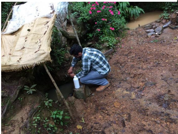
Fotografía 3. Toma de muestra para análisis bacteriológico. El Durazno, 2020
