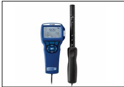
Figura 1. Medidor de calidad de Aire IAQ-Calc™ JZ-86384-15
