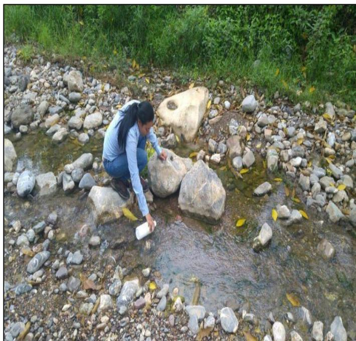
**Imagen 16.** Segundo monitoreo, toma de muestra para análisis fisicoquímicos
