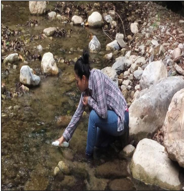
**Imagen 13.** Toma de muestra para análisis fisicoquímicos
