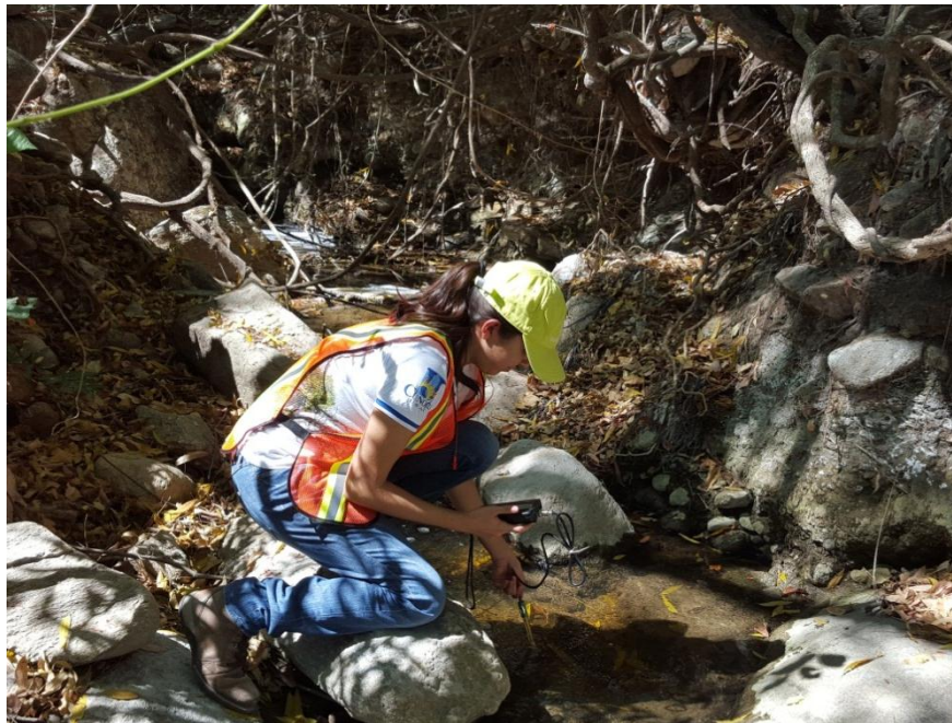
Figura 2. Medición de pH y temperatura del agua proveniente de los canales de aireación.
